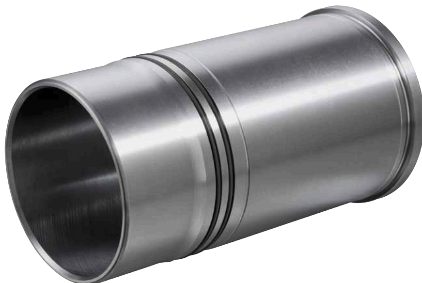
Die nasse Zylinderlaufbuchse am Motorblock. Ein O-Ring dichtet gegen das Kühlwasser ab, der zweite O-Ring gegen das Motoröl.
